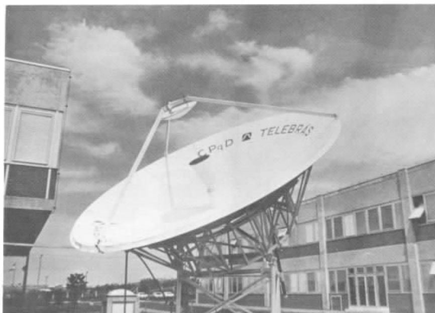
Desenvolvida no CPQD, a antena para recepção e transmissão de sinais via satélite já foi transferida para a indústria.
