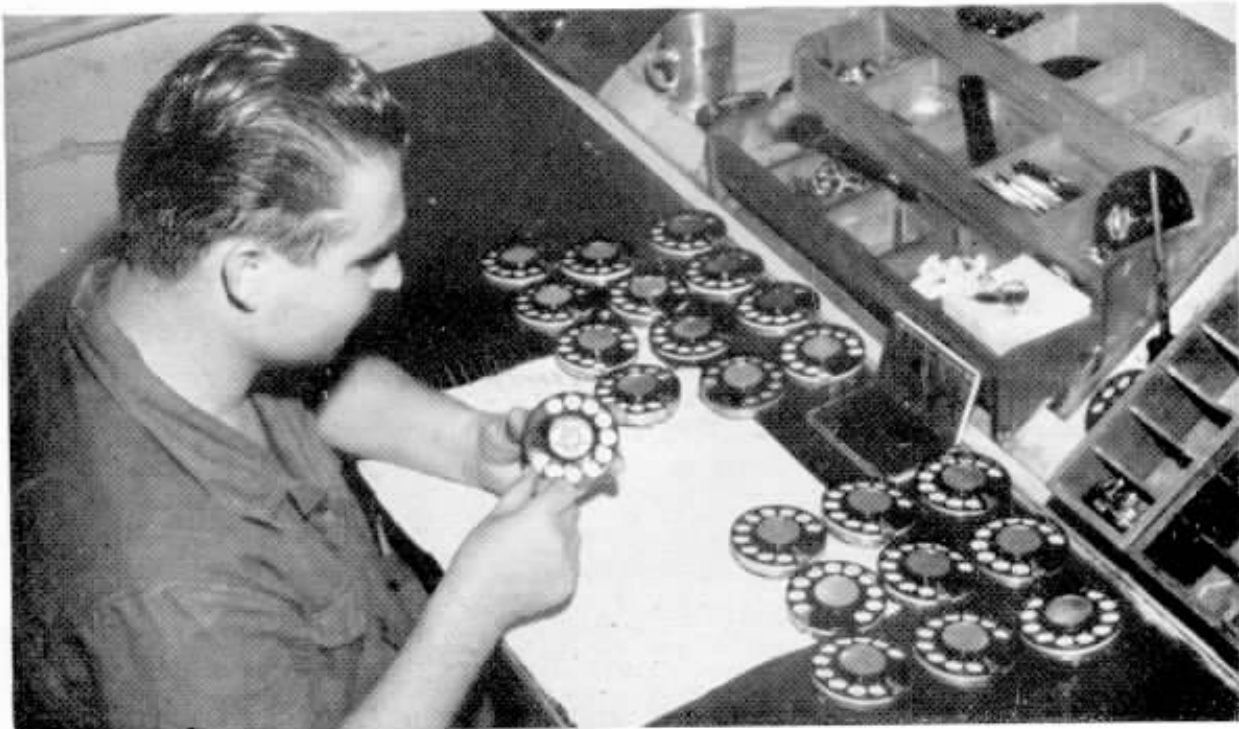
Pompeu Rodrigues, na Divisão da Guanabara, exerce trabalho semelhante: ele-lo fazendo o exame minucioso e preciso dos discos que irão servir aos aparelhos telefônicos recuperados.
