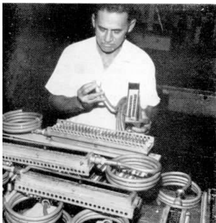
Reparo e montagem de terminais de cabos, Gustavo Campos, encarregado, dá o seu OK.
