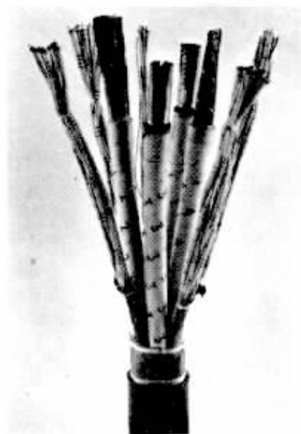
Tipo do cabo coaxial utilizado no sistema de discagem direta de Santos a S. Paulo
