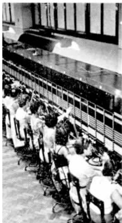
O assinante discia 01 e a chamada vai à mesa 1U, onde a telefonista anota o pedido de ligação.
