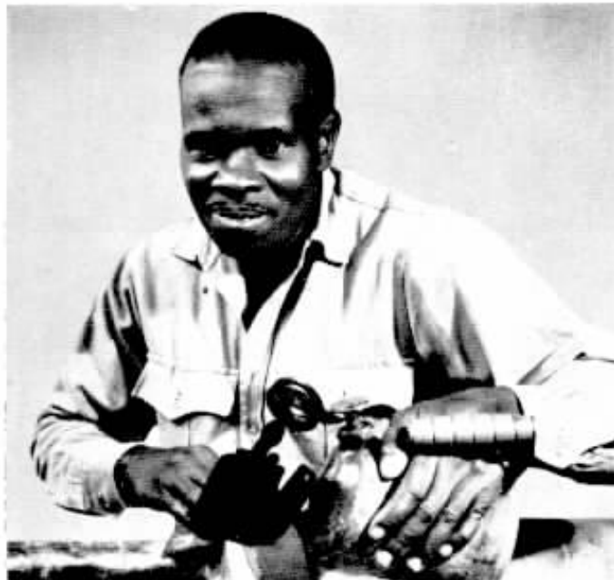
Gervásio L. Macias, após o fechamento da emenda, num teste de segurança com gás nitrogênio, para prevenir contra possível porosidade na superfície soldada.
