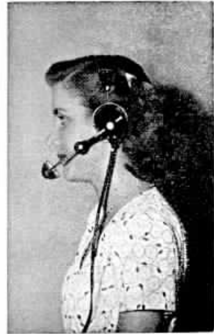
Novo aparelho de telefonista, tipo 52-AW-WE, visto de frente e de lado.
