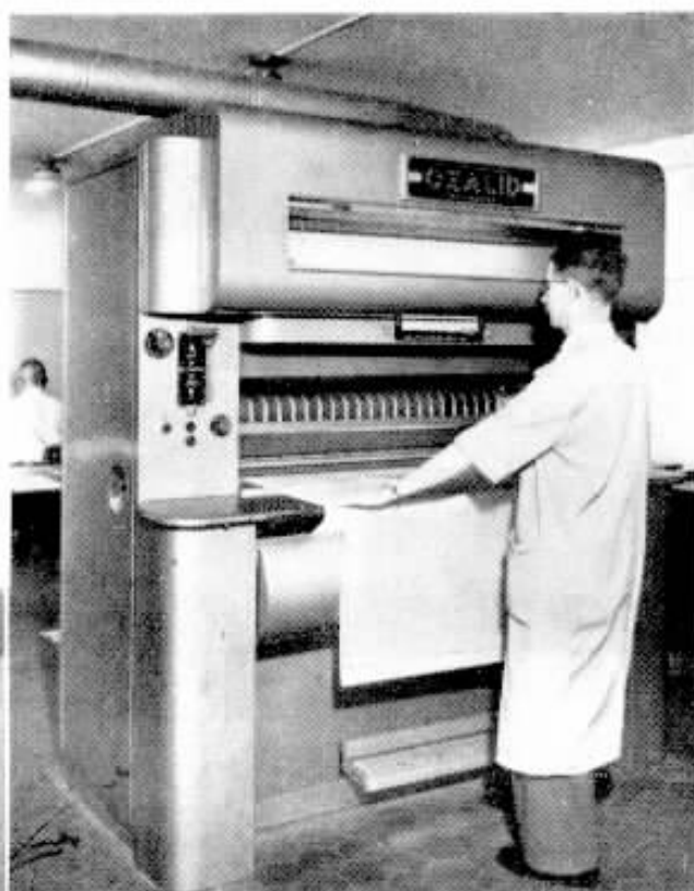
A moderna copiadora "Ozalid Print Master", de grande produção e eficiência, que copia e revela desenhos ou cópias datilografadas por sistema eletrônico, com uma produção até duzentas ou mais cópias por hora ou o máximo de nove metros por minuto
