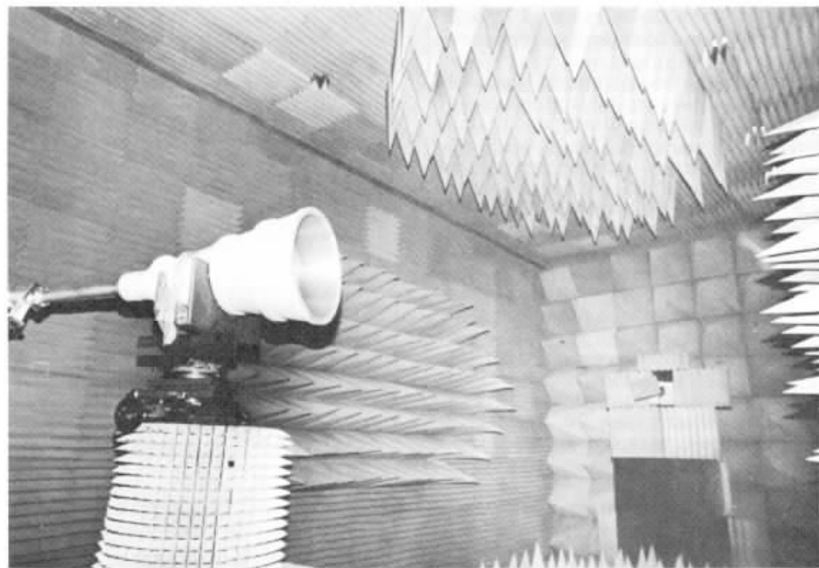
Totalmente revestida de espuma de poliuretano, a câmara anecoica (sem eco) reproduz o espaço livre para desenvolvimento de antenas.
