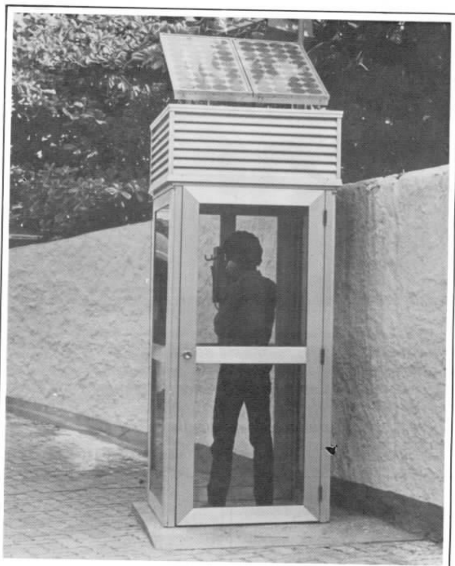
O painel, formado por várias células solares, coleta a energia que faz funcionar o sistema de transmissão da cabine.
