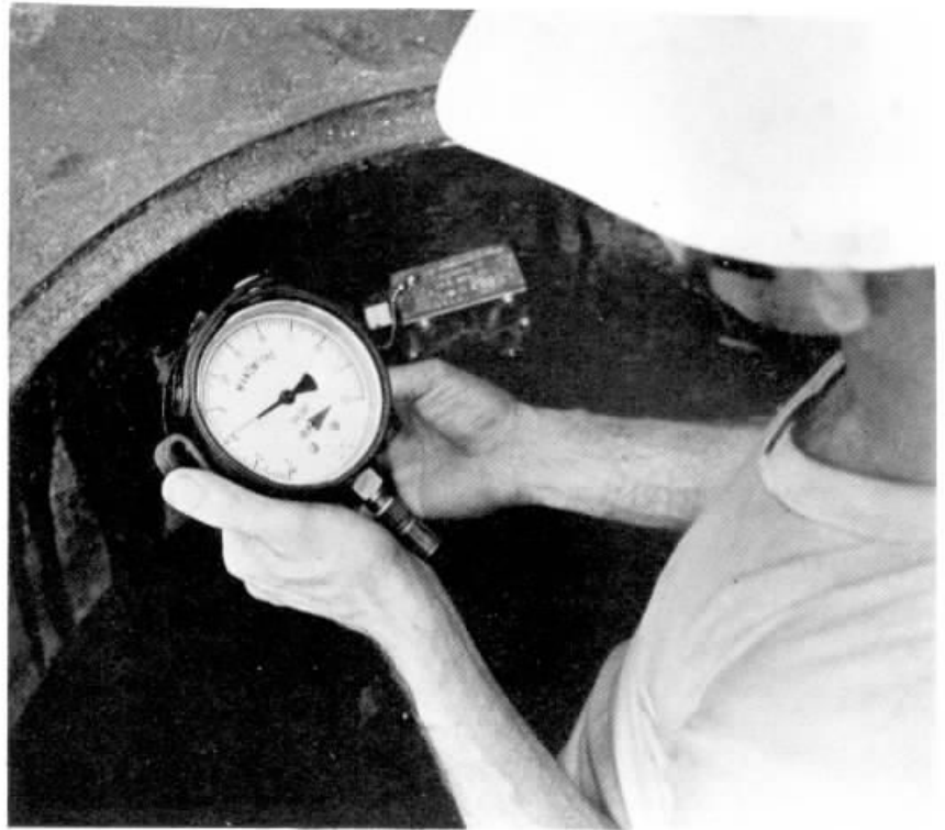
Alertados do vazamento, os técnicos descem à galeria e medem a pressão dos cabos com o manômetro.
