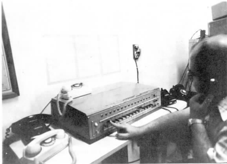
A mesa a magneto pode ser conectada aos circuitos de microondas da Embratel.
