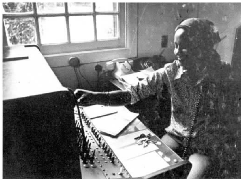
A mesa PBX, do Hotel Pinheiros, opera com quatro troncos e 28 ramais.
