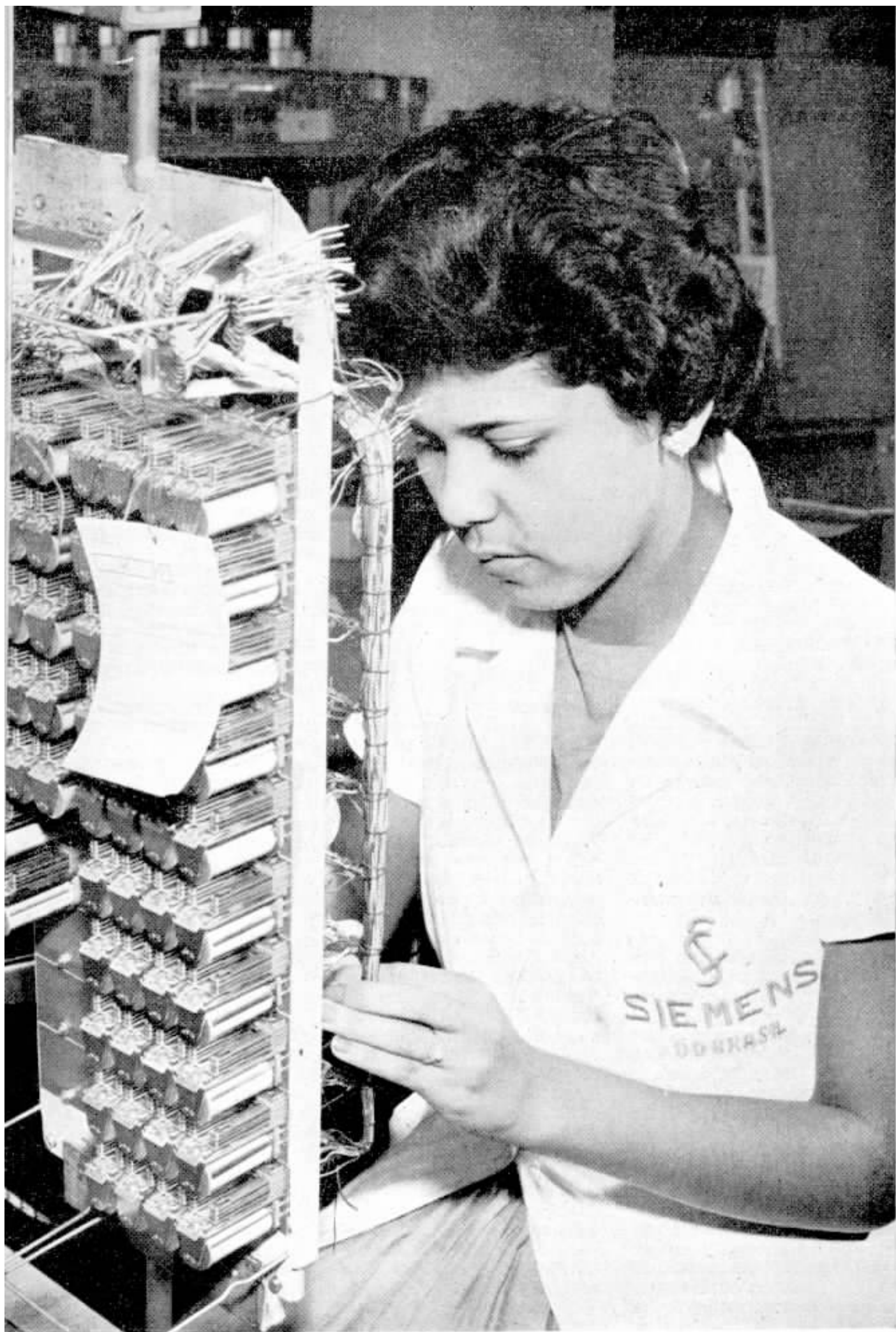
Diligente operária, especialista na montagem de centros automáticos da Siemens do Brasil.
