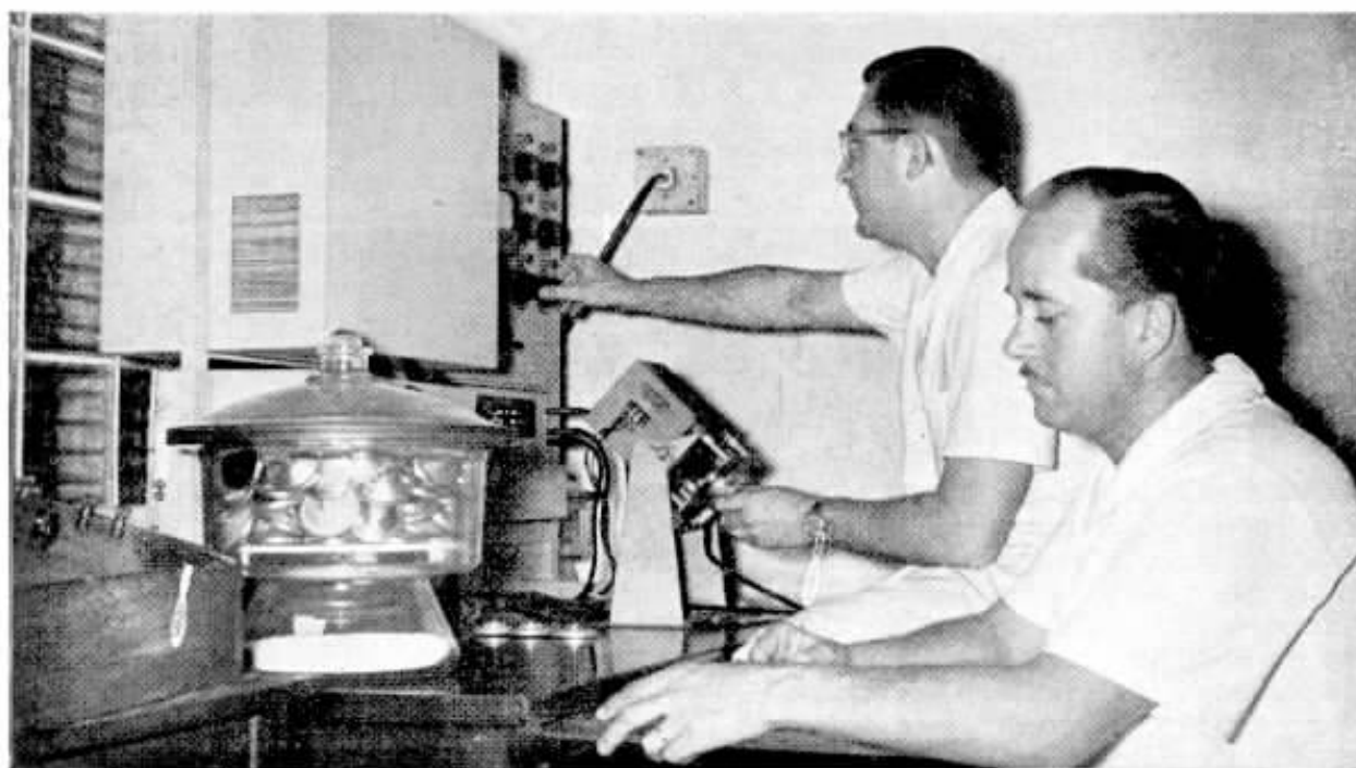
O Eng o Carlos Cava e Luiz A. Oliveira, testam transmissores telefônicos na boca artificial, determinando as características eletracústicas, trabalho que exige muita atenção.
